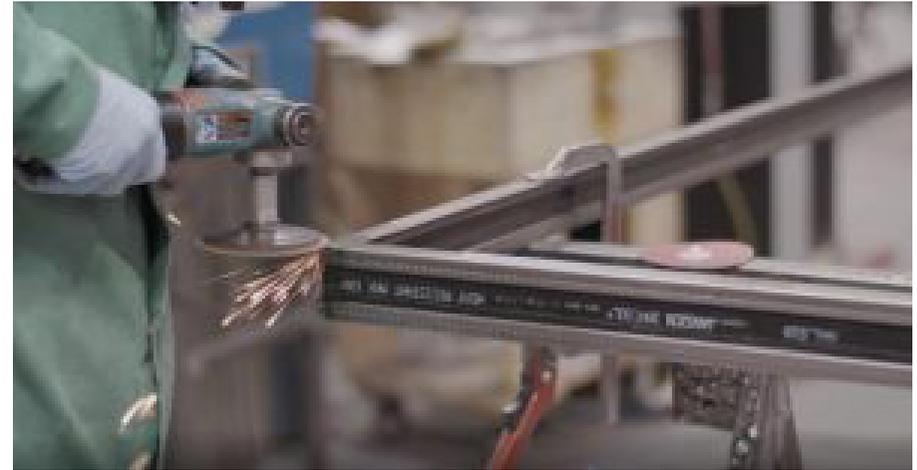
*GRIND WELDS TO FLUSH SEAMLESS SURFACE*
